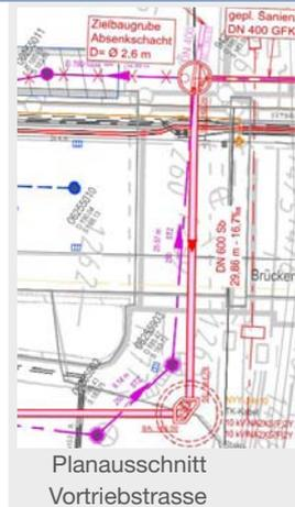
Aufgrund statischer Erfordernisse durch den naheliegenden Fuß der Burtscheider Brücke wird der Übergabeschacht als Absenkschacht mit einem Durchmesser von 2,6 m ausgeführt. Dieser dient gleichzeitig als Zielbaugrube für den Rohrvortrieb. Mit Hilfe zweier innenliegender und eines außenliegender Absturzes wird die Höhendifferenz von insgesamt ca. 6,5 m zwischen Übergabeschacht und Bestandsschacht überwunden.
